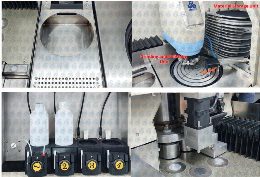
UNIPOL-1210M 全自动金属组织研磨与抛光系统是一款集自动镶嵌、研磨、抛光和清洗单元于一体的综合解决方案。它能够在 40 - 60 分钟内实现从镶嵌到样品制备以及最终清洁的无缝自动化工作流程，确保一致性与效率。该系统适用于多种材料，如金属、陶瓷和岩石样本。
