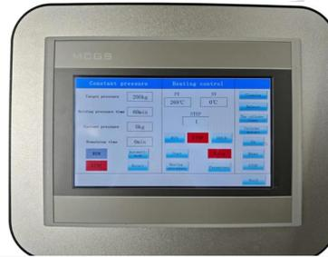
GBF-1700RHP4 是一款在手套箱内配备快速冷却功能的快速热压机 (RHP)。样品通过感应加热以约~1°C/秒的速度升温至 1600°C，并使用 5 T 电动压机施加压力，最大压强 100MPa。内置水冷铜模，可使样品以约 > 8°C/秒的速度快速冷却。
