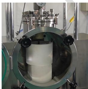
KSL-VMW-1400 是一款微波加热炉，采用不锈钢真空腔体，可在真空或气氛保护环境下对样品快速加热，最高温度可达 1400°C，最大加热速率 100°C/分钟。
