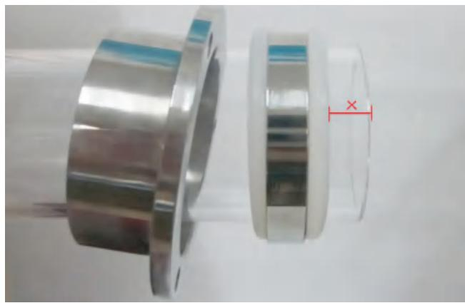
安装时请确保密封圈2与炉管端面的距离即图中X的距离不能超过10mm，如果超过，在安装外法兰时很容易损害炉管。
