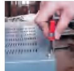
(1) 拧下上盖板四只螺丝，打开炉体上盖板，
