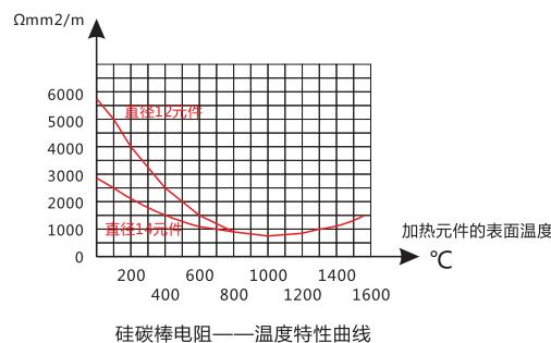
由图可见发热体电阻呈凹曲状，约 $850 \pm 50^\circ\text{C}$ 时，电阻率为最小值，在此温度点之后，温度增高电阻率相应增大。温度超过 $1500^\circ\text{C}$ 时，老化速度加剧，并将元件迅速烧毁。
