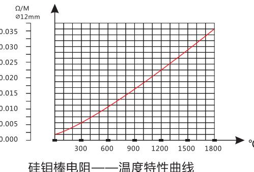
二硅化钼电热组件的电阻率随着温度的升高而迅速增加。在正常操作情况下，组件电阻一般不随使用时间的长短而变化。因此，新旧组件可以混合使用。
