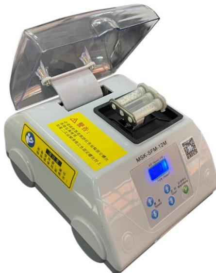
MSK-SFM-12M 是一种高功率微震动球磨机和混料机,适用于少量物质球磨和混料。在 2ml 的一次性螺丝微管里 3 个样品可以同时混料(通常在 45 秒完成)。通过选择,专门为你的样品匹配的氧化锆微球高速冲击,可以优化混料模式。MSK-SFM-12M 是专门为传统混料机难以混合均匀的高强度样品开发设计的。它方便,经济,是代替传统高价混料器的理想之选。
